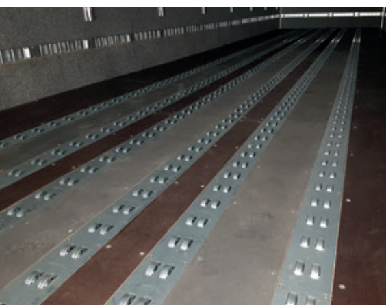
Linie im Detail mit rutschhemmendem Boden
