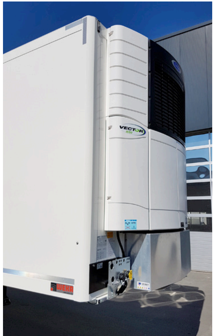
Förderantrieb mit Kühlmaschine
