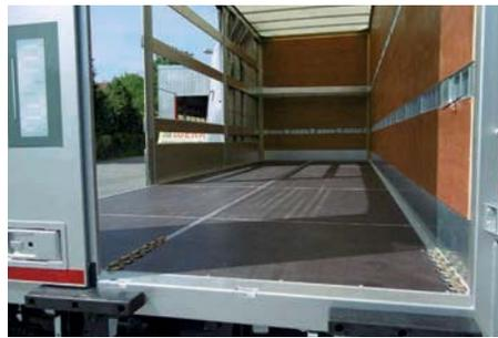
*Bolzenzurrlleisten und Bodenschienen*
