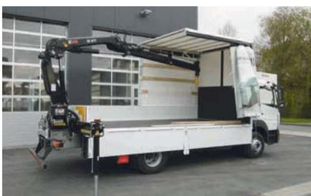
Heckkran mit halben Pritschenaufbau
