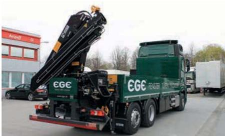
Heckkran mit Bordwand Aufbau
