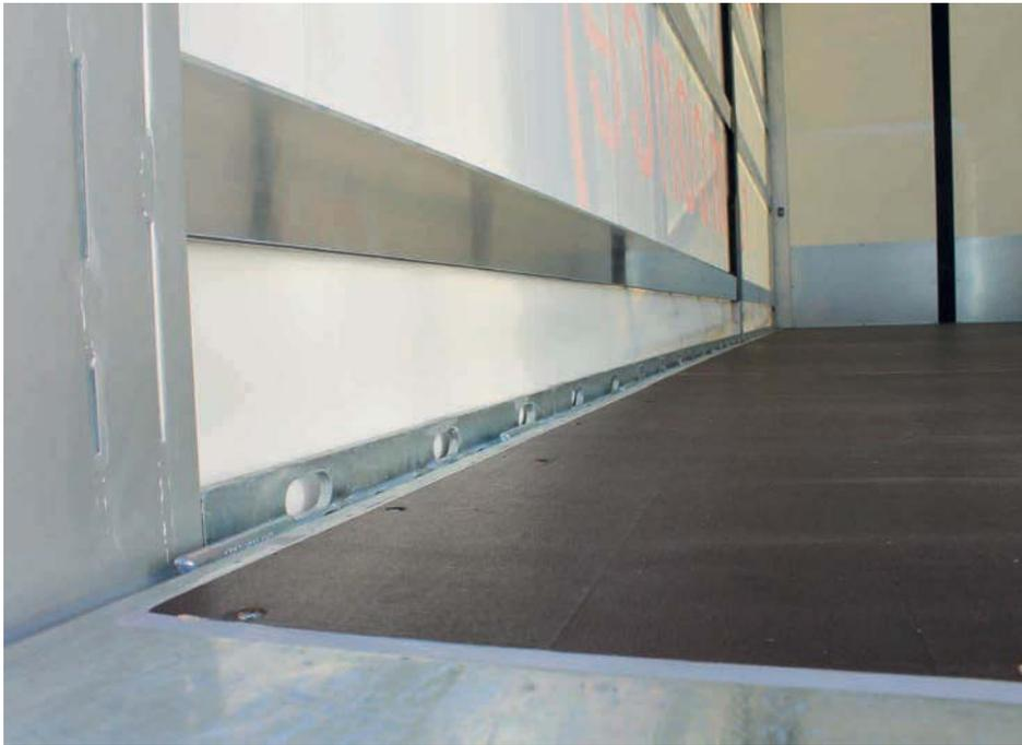
*Paletten-Anschlagkante gelocht für Spanngurte*
