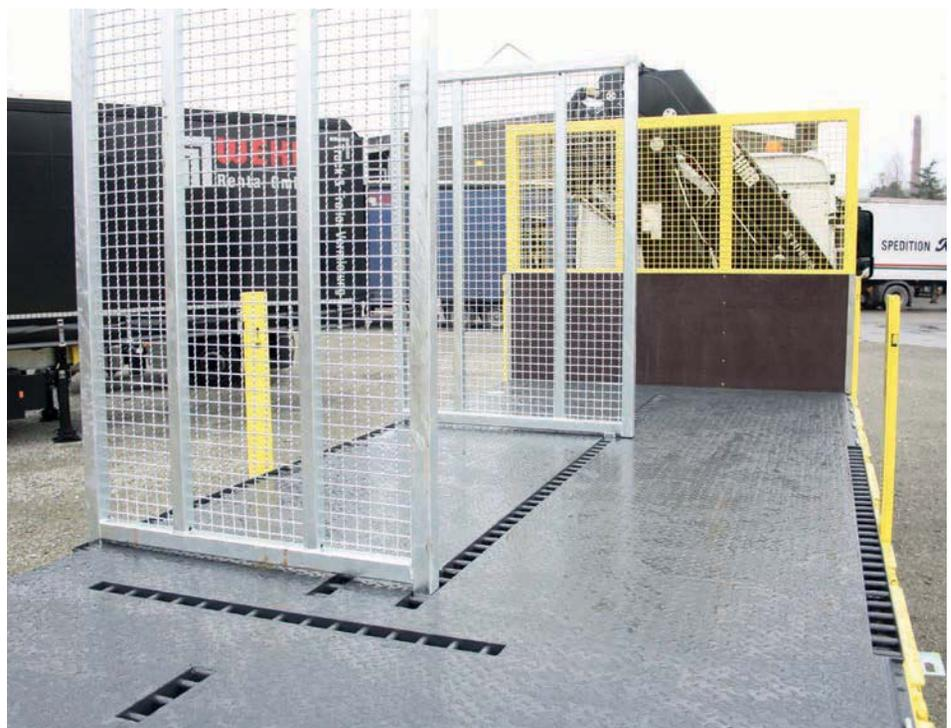
*verstellbare Trennwände über Steckungsschienen*
